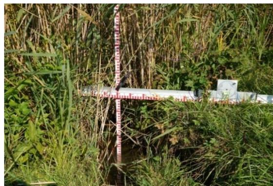
Abb. 19: Bestimmung der Uferhöhe (bei Ausstieg)
